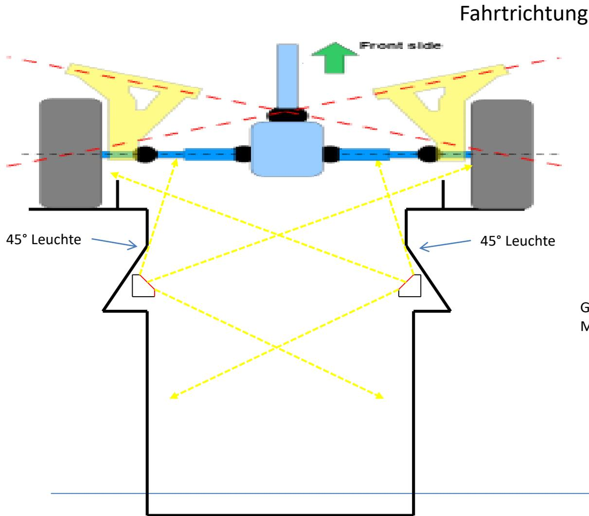
Grubenausleuchtung mit variable Montage Möglichkeiten - 45° oder runde Leuchten.
